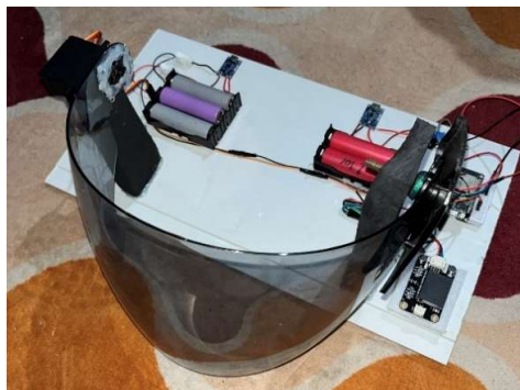
Gambar 3. Hasil Perancangan Hardware Sistem Buka Tutup Kaca Helm Menggunakan Voice Recognition Module Berbasis Mikrokontroler
