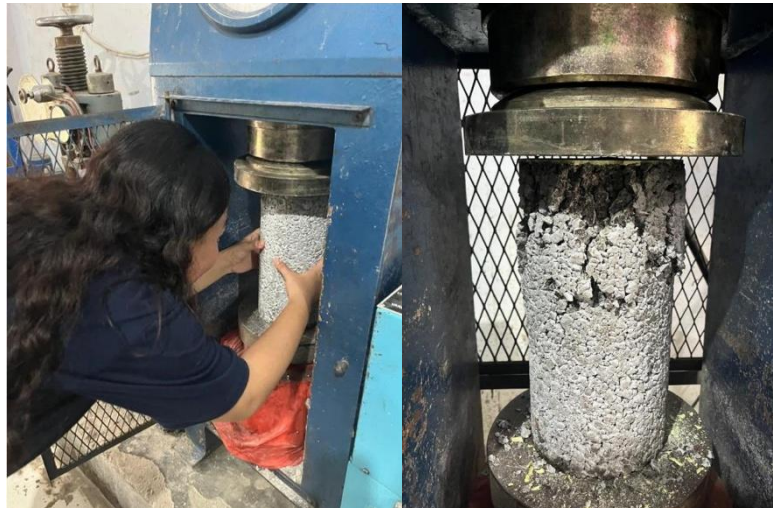
Gambar 5. Deskripsi Uji Kuat Tekan
