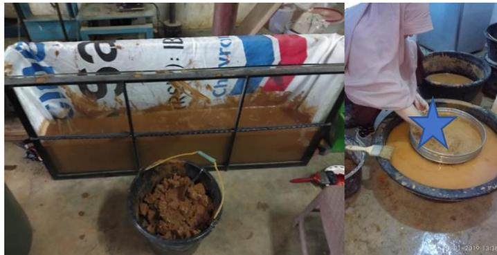
**Gambar 1.** Tanah Lempung Lunak Jenuh Air di Dalam Boks Kaca
