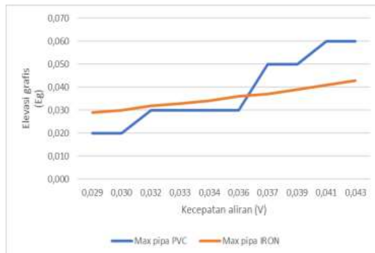
Gambar 3. Grafik Hubungan Maximal Sambungan Pipa PVC 90° dan Iron 90°
