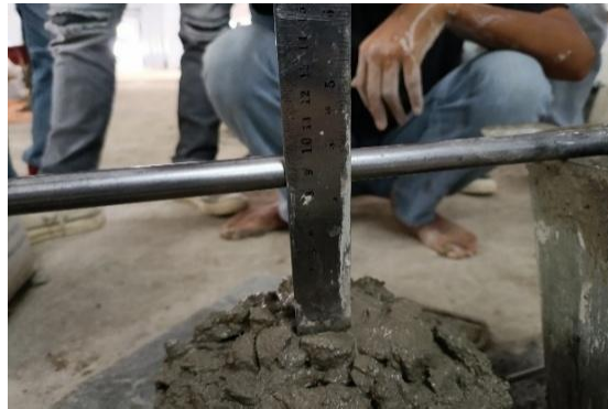
Gambar 2. Pengujian Slump Beton
