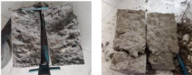
Gambar 5. Dokumentasi pengujian tarik belah pada benda uji
