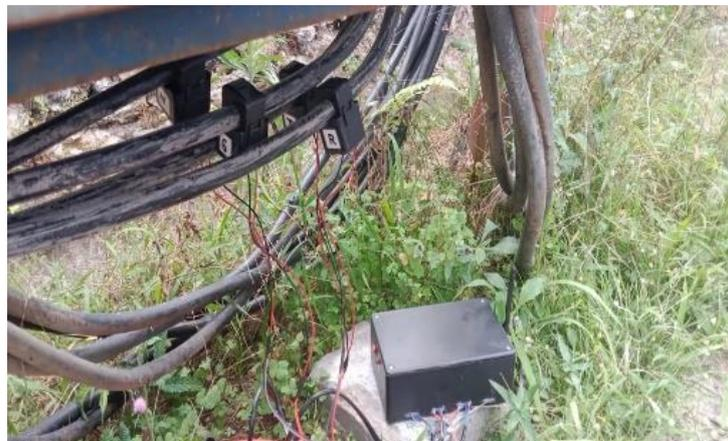
**Gambar 4.** Pemasangan Sensor Arus
