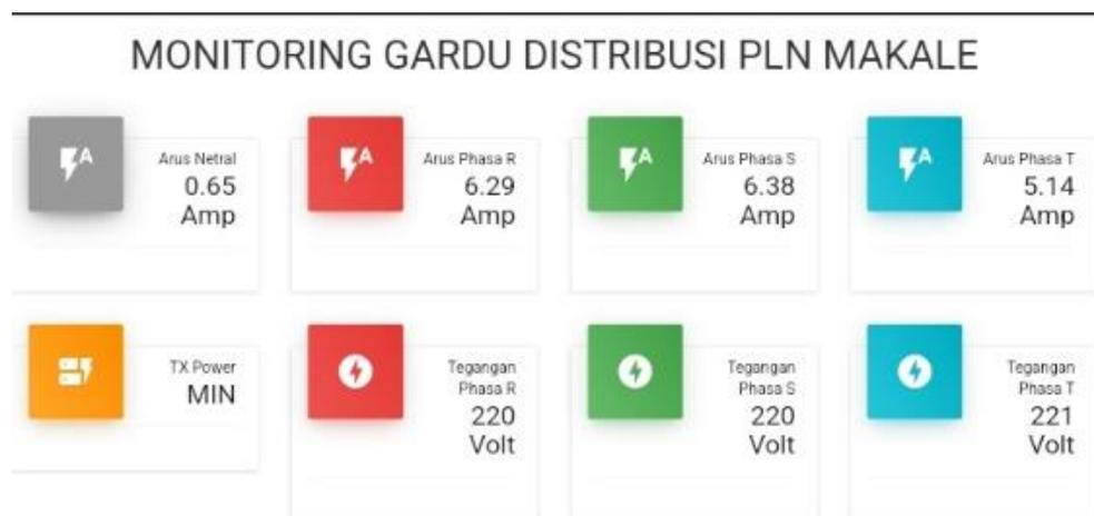
**Gambar 7.** Tampilan Nilai Arus dan Tegangan pada Firebase
