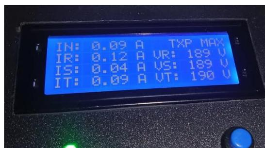
**Gambar 6.** Tampilan Nilai Arus dan Tegangan Pada LCD
