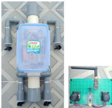
Gambar 4. Rancangan Mekanik Sistem Kendali dan Navigasi pada *Prototype* USV.
