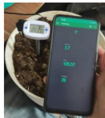
Gambar 3. Perbandingan Pembacaan Alat Ukur dan Sensor
