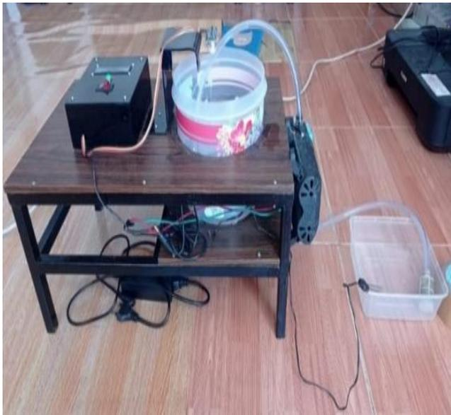
Gambar 2. Prototype Sistem Penyiraman Tanaman Otomatis
