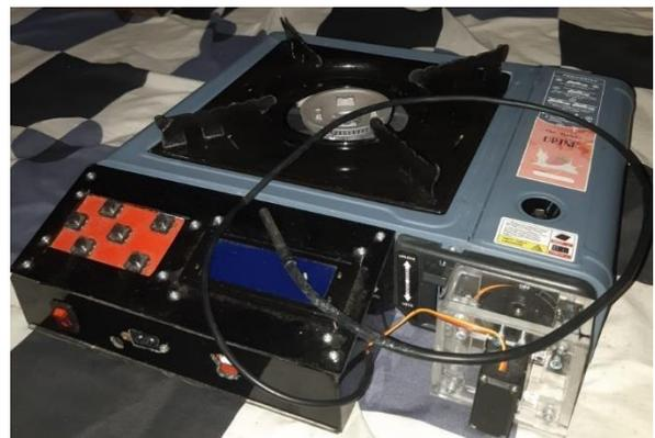
Gambar 3. Kompor Gas Otomatis
