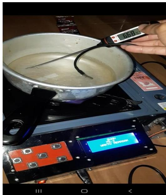
Gambar 5. Pengujian Memasak Air
