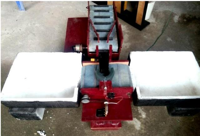
Gambar 2. Bentuk Konstruksi Alat Pemilah Telur Otomatis
